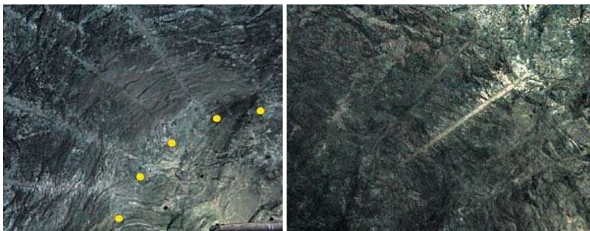
2.7 Сурет – Жоғарыда-бірінші жарылыстан кейін ұзындығы 1,6 кг/п. м зарядпен зарядталған өндіріс контуры.; Төменде-бірдей параметрлері бар үшінші жарылыс
