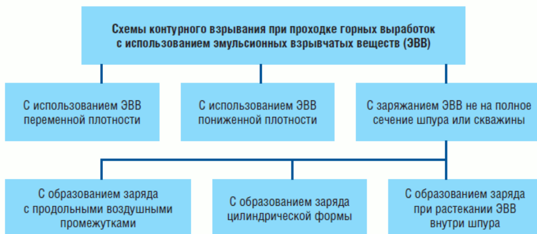
2.1 – Сурет - Эмульсиялық жарылғыш заттарды пайдалану кезіндегі Жиектеуші жарылыс схемалары
