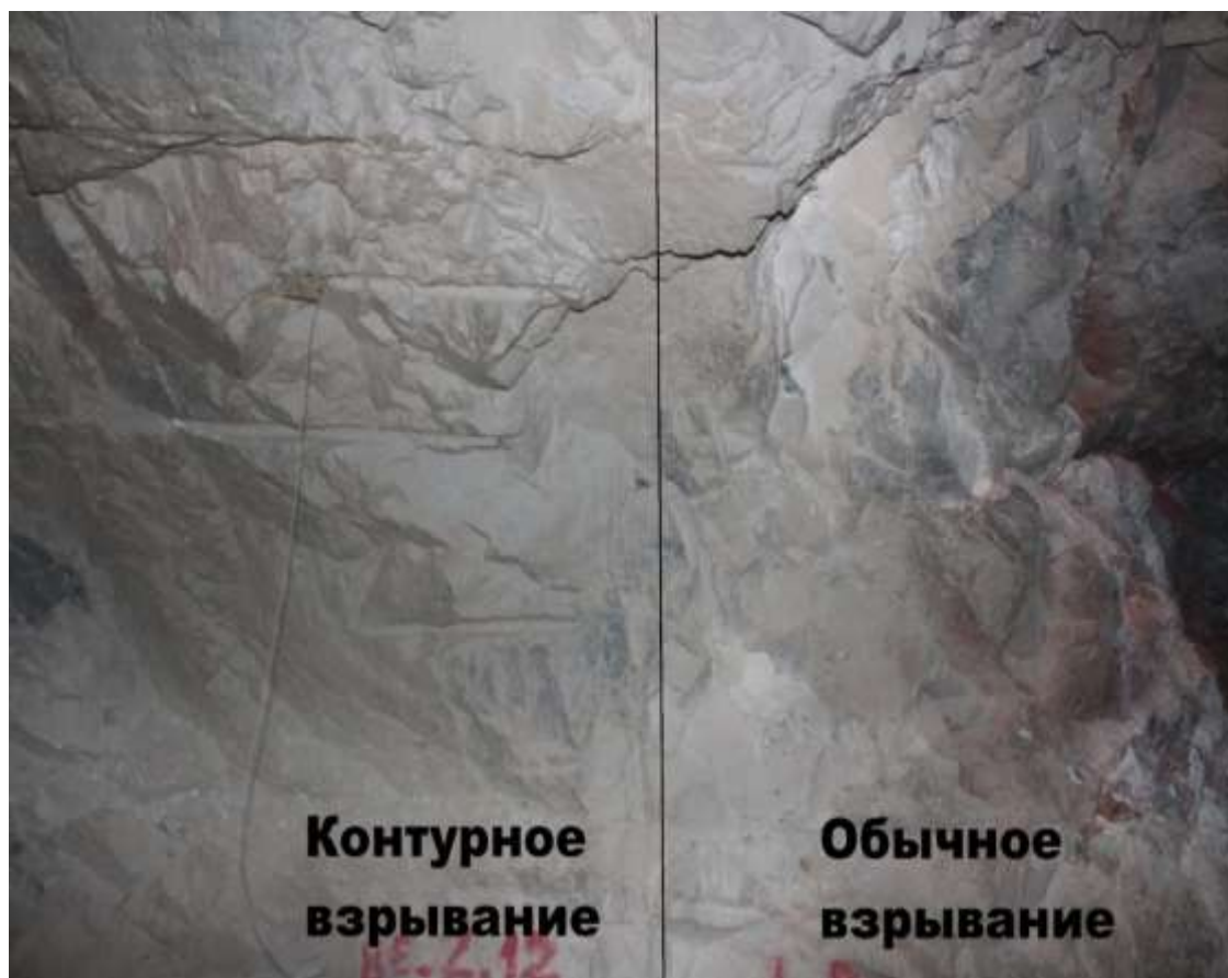
4.13 Сурет – Қазбаның бүйірлеріндегі тәжірибелік жарылыстың нәтижелері
