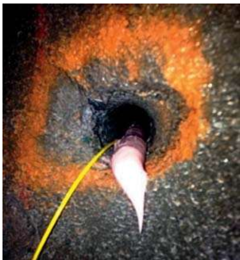
2.2 Сурет – Технология бойынша диаметрі 54 мм зарядталған теспелер Өнімнің шығыны 0,6 кг/п. м. (сол жақта) және өнімнің шығыны 1,2 кг/п. м.
