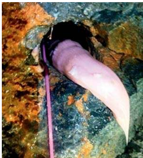
2.2 Сурет – Технология бойынша диаметрі 54 мм зарядталған теспелер Өнімнің шығыны 0,6 кг/п. м. (сол жақта) және өнімнің шығыны 1,2 кг/п. м.
