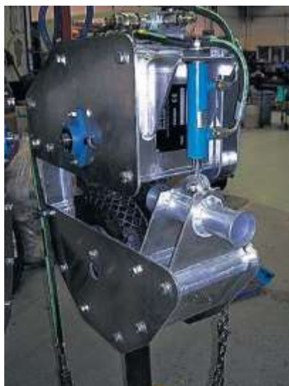
2.6 Сурет – «Апатит» АҚ жер асты кеніштерінде сыналған шланг бұрғыш
